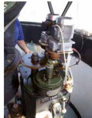
Figura 5. Labores de mantenimiento del mecanismo de giro en el Faro del Cabo de Gata. En la imagen de la derecha se observa la cubeta tórica de mercurio para facilitar el giro de la óptica.
