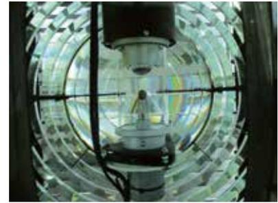
Figura 3 Sistema de lamas Otter (izda.) delante de la óptica (dcha.) en el Faro de Isla Sálvora. Este sistema permite señalar la orografía cercana al Faro. Es uno de los dos mecanismos Otter existentes en el mundo.
